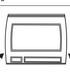
INSERT CLOCK/HAZARD SWITCH ASSEMBLY FROM REAR OF 99-8214 RADIO HOUSING TRIM PANEL
